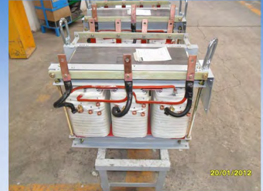
Transformador Trifásico Tipo Seco Aislamientos de NOMEX-MAYLAR-NOMEX
